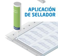
Se debe evitar el uso de adhesivos o mastique. Para el correcto sellado se deberá utilizar únicamente sellador neutro, nunca usar silicón acético (de usos generales). El cordón de sellado debe abarcar mínimo 1 cm.
