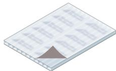
Todos los laminados Macrolux son entregados con una película plástica protectora por ambos lados. La película plástica con letras impresas no debe ser retirada hasta que la lámina haya sido instalada. Esto con la finalidad de identificar perfectamente la cara con protección contra los rayos UV (cara expuesta a los rayos solares).
