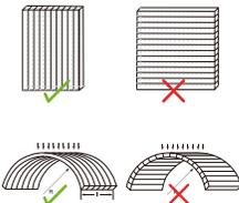
Las celdas o canales deben instalarse de manera vertical para permitir el drenaje del agua, producto de la condensación. La pendiente mínima será del 10% o 5°.
