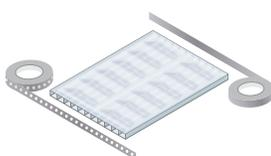
Retirar las cintas temporales de las orillas y sustituirlas con cinta aluminio en la parte alta de la instalación y cinta ventana en la parte baja del laminado. Esto con la finalidad de prevenir la entrada de polvo y suciedad, y permitir un buen drenado de la condensación. Cuando sea en arco cañón se debe colocar la cinta ventana por ambos lados.
